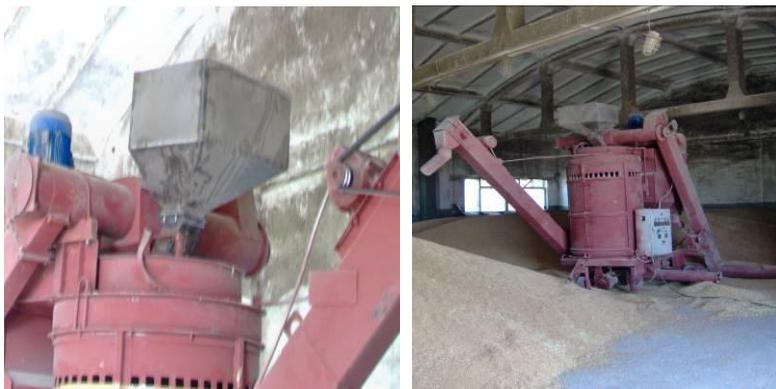
Рис. 2. Модернизированный СВС–15 с бункером для испытаний на искусственно–составленных ЗС
