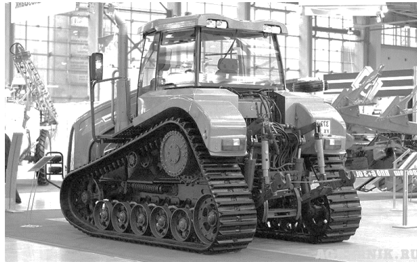
Рис. 4 – Гусеничний трактор Агромаш-Руслан
