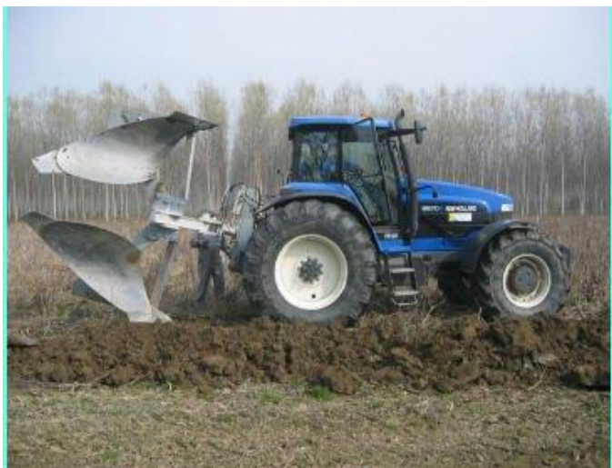
Рис. 18. Плуг плантажний ППУ-50
