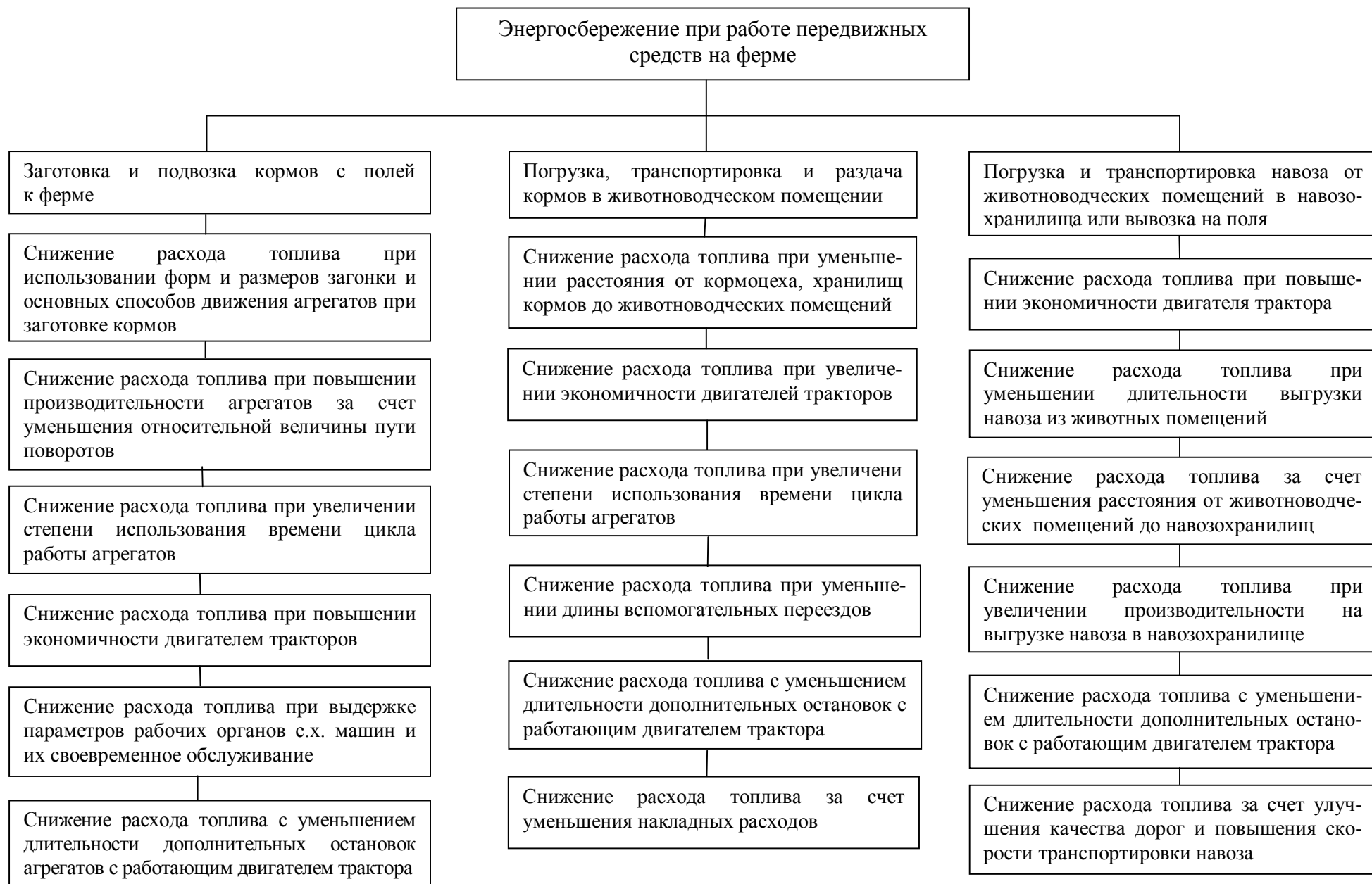
Рис. 1. Схема факторов, влияющих на энергосбережение при работе передвижных средств на животноводческой ферме
