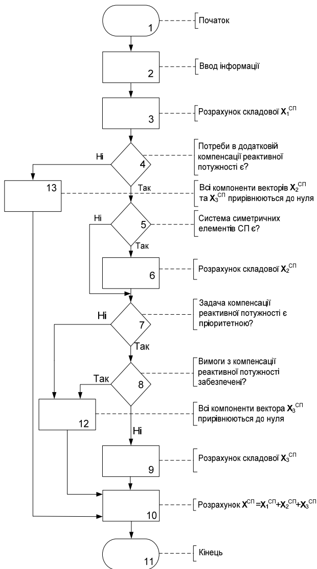
Рисунок 1- Блок-схема алгоритму розрахунку вектора керування X^{СП}
