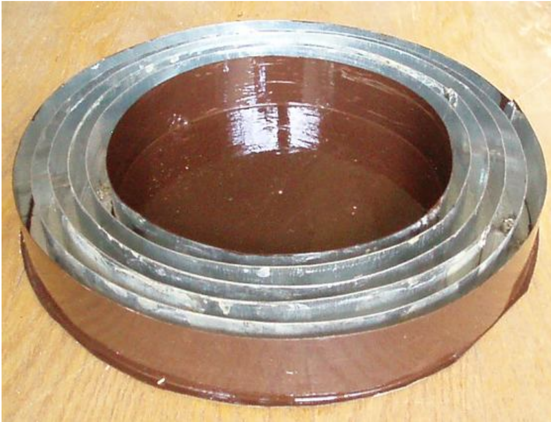
Рис.1. Загальний вигляд пристосування для визначення глибини занурення частинок в розріджений шар комбікорму
