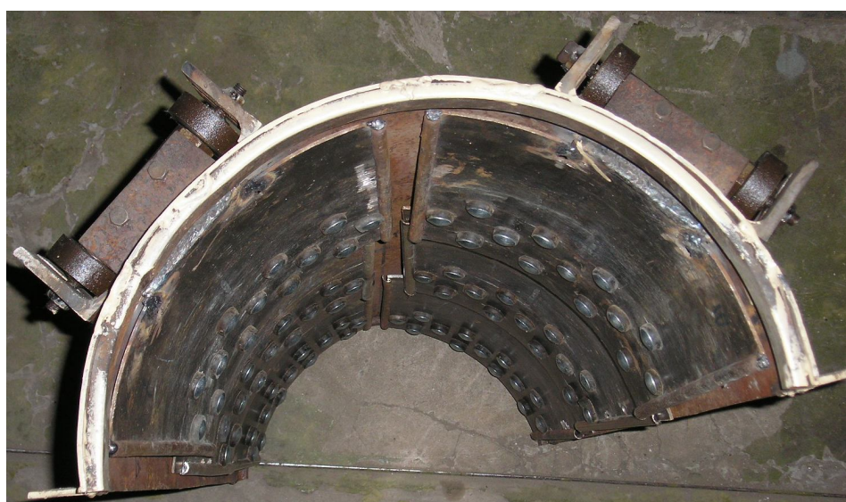
Рис.2. Верхняя половина деки молотилки початков кукурузы разработанной в Луганском НАУ.
