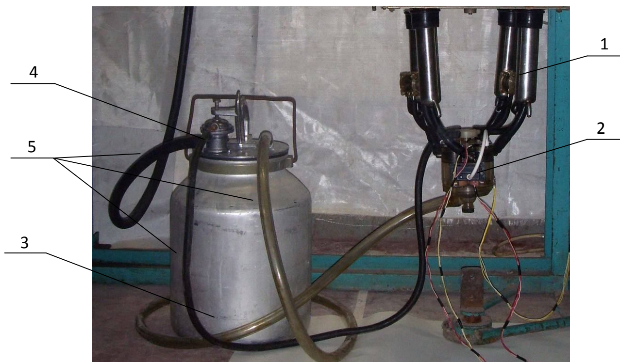
Рисунок 1 – Доильный аппарат: 1 – двухкамерные доильные стаканы с регуляторами вакуумметрического давления; 2 – коллектор; 3 – доильное ведро; 4 – пульсатор; 5 - соединительные патрубки
