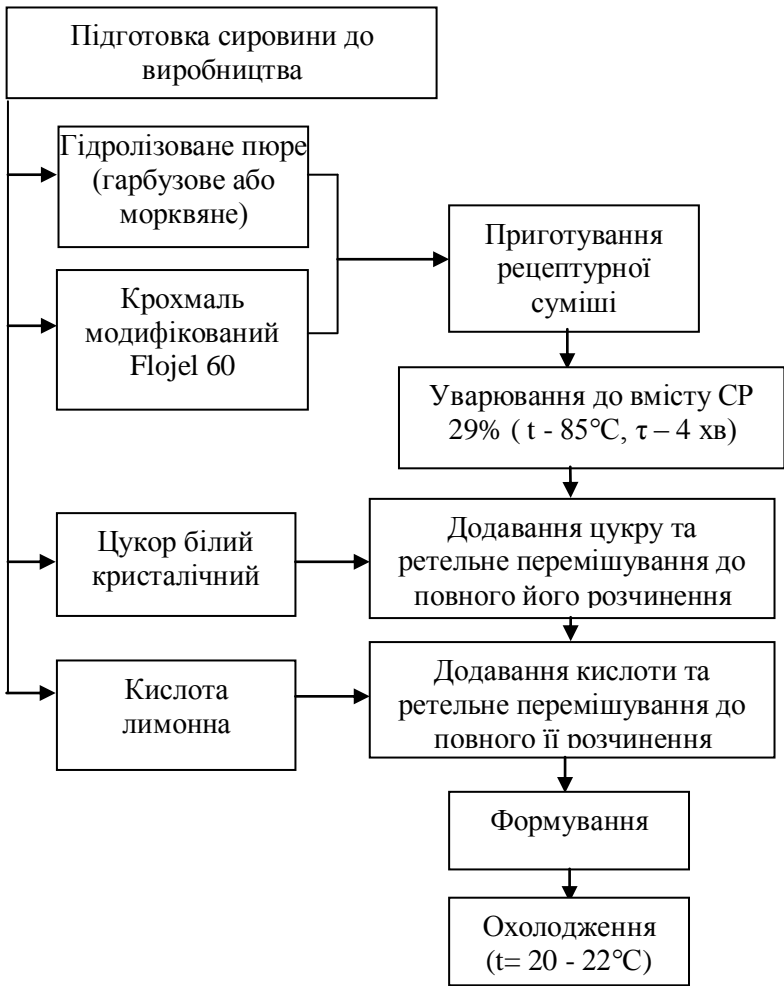
Рис. 8. Принципова технологічна схема виробництва драгледоподібного оздоблювального напівфабрикату на основі гарбузового або морквяного гідролізованого пюре з використанням у якості структуроутворювача кукурудзяного крохмалю, модифікованого кислотою
