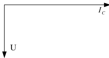
Рис. 2.12. Векторна діаграма кола змінного струму з ємністю
