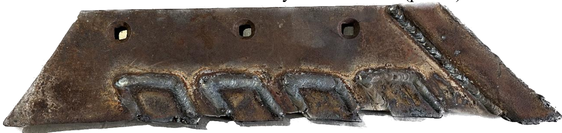
Рис. 3 Плужний леміш з постановкою компенсуючих вставок
