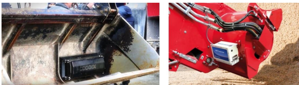
Рис. 1 - Анализаторы кормов, встраиваемые в рабочие органы машин.
