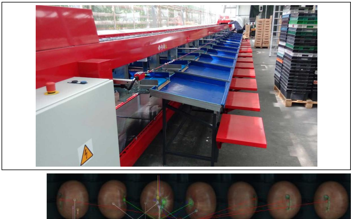
Рис. 17. Стаціонарний пункт сортування томатів (джерело: http://www.novtech.com.ua/oborudovanie/sortirovka/opticheskaja-sortirovka/ )
