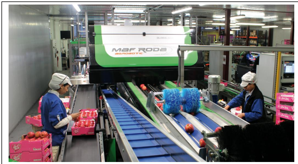
Рис. 7. Лінія товарної обробки яблук MAF RODA (Франція) (джерело: https://www.maf-roda.com/en/page/novacoop-automatic-robot-packing-
