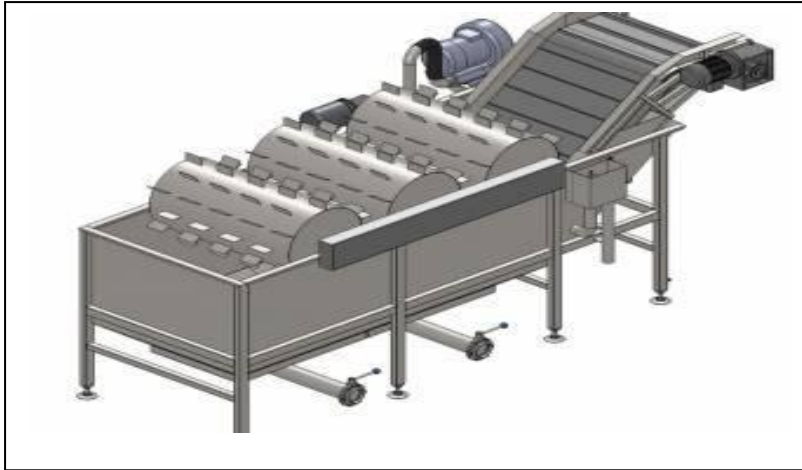
Рис. 16. Мийна машина для невеликих партій коренеплідних овочевих культур ПрАТ «Каховський експериментальний механічний завод»
