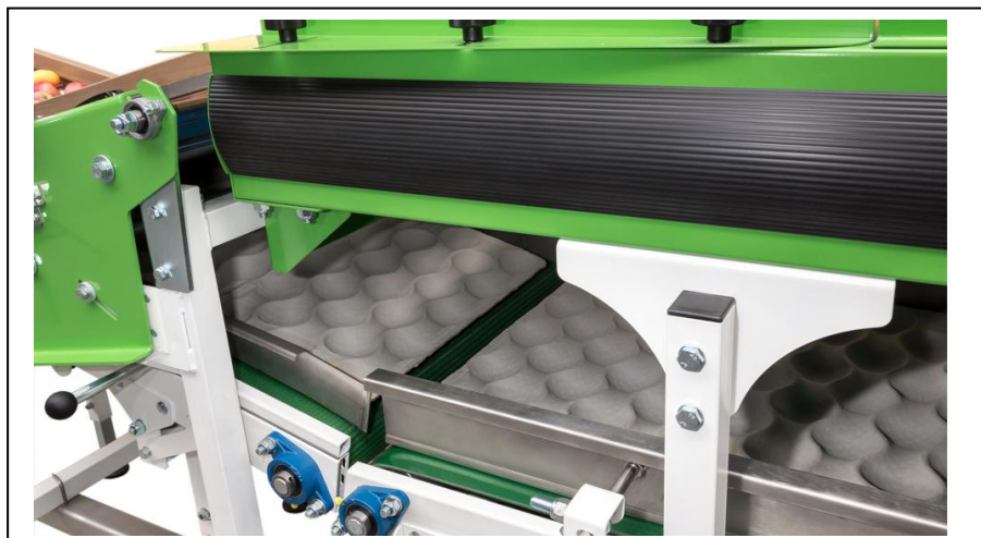
Рис. 6. Автоматична лінія для пакування фруктів на підкладку (альвеоли) (джерело: https://www.sorter.pl/pl )
