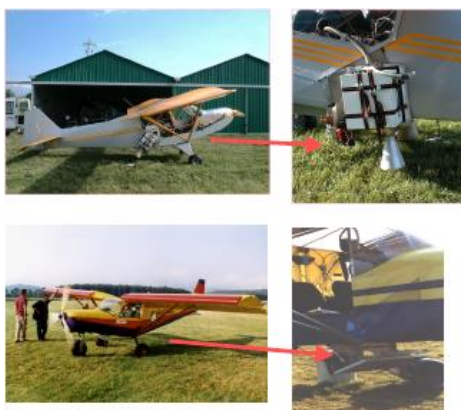
Рис. 3. Варіанти встановлення міліметрового радіометра та антен на борту двох надлегких літаків
