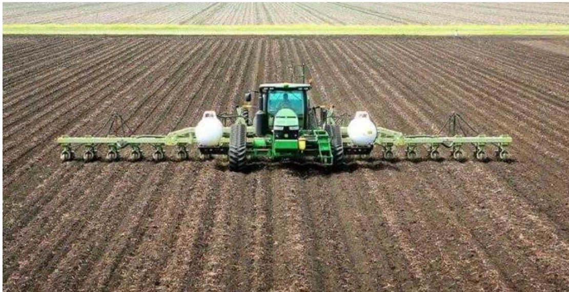
Рис. 1. Розпушення ґрунтів смугами у рядках за технологією Strip-till
