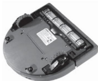
Рис. 1. Вид знизу на двоколісний робот
