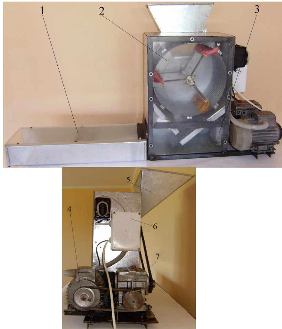
Рис. 1. Загальний вигляд установки для відокремлення крила від насіння сосни з повітряним каналом: 1 – повітряний канал; 2 – камера відокремлення; 3 – вентилятор; 4 – електродвигун; 5 – бункер; 6 – блок управління; 7 – редуктор
