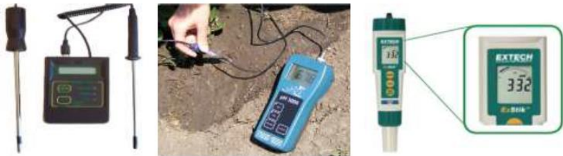
Рис. 2.1. Технічні засоби вимірювання агрономічних даних: вологомір ґрунту, рН-вимірювач (кислотності ґрунту), прилад для вимірювання вологості.
