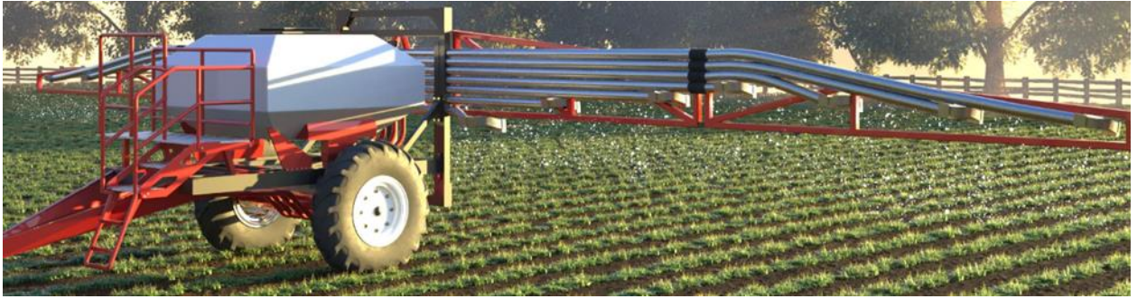
Рисунок 1. Пневматична машина диференційованого внесення твердих мінеральних добрив.
