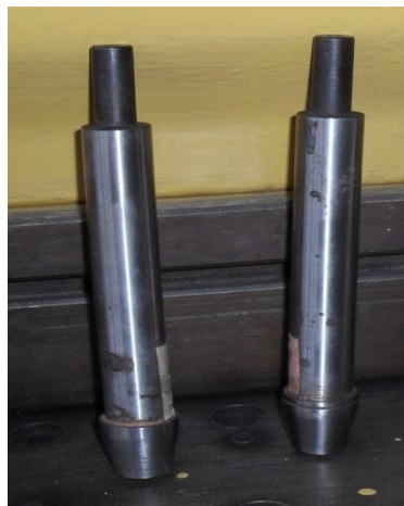
Рис. 3 - Пуансони для деформування втулок
