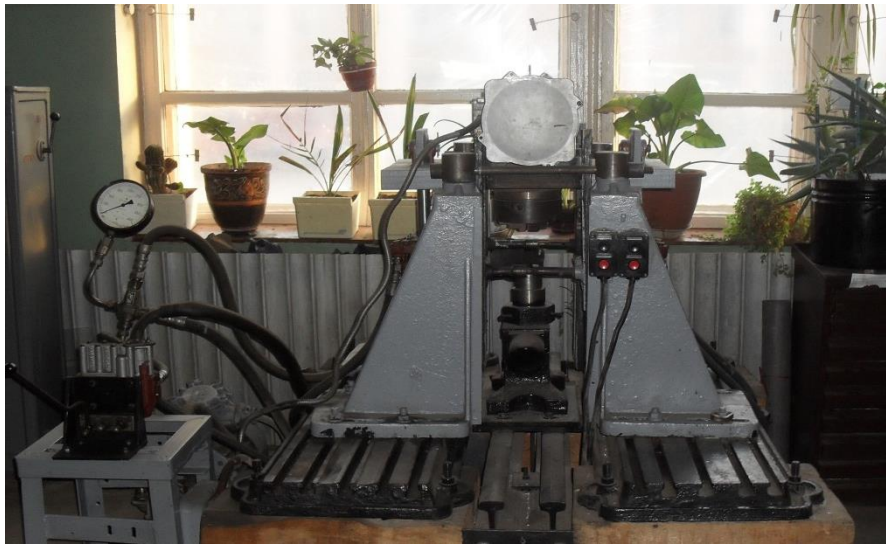
Рис. 1 - Експериментальна вібодетформаційна установка
