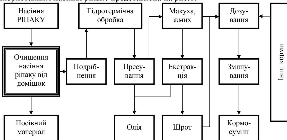
Рисунок 1 – Технологічна схема підготовки кормосумішей з використанням насіння ріпаку
