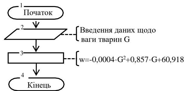
Рисунок 3 - Блок-схема алгоритму визначення за виразом (1) кількості виділення вологи однією твариною молодняку ВРХ віком від 6 місяців при температурі навколишнього середовища +10 °С
