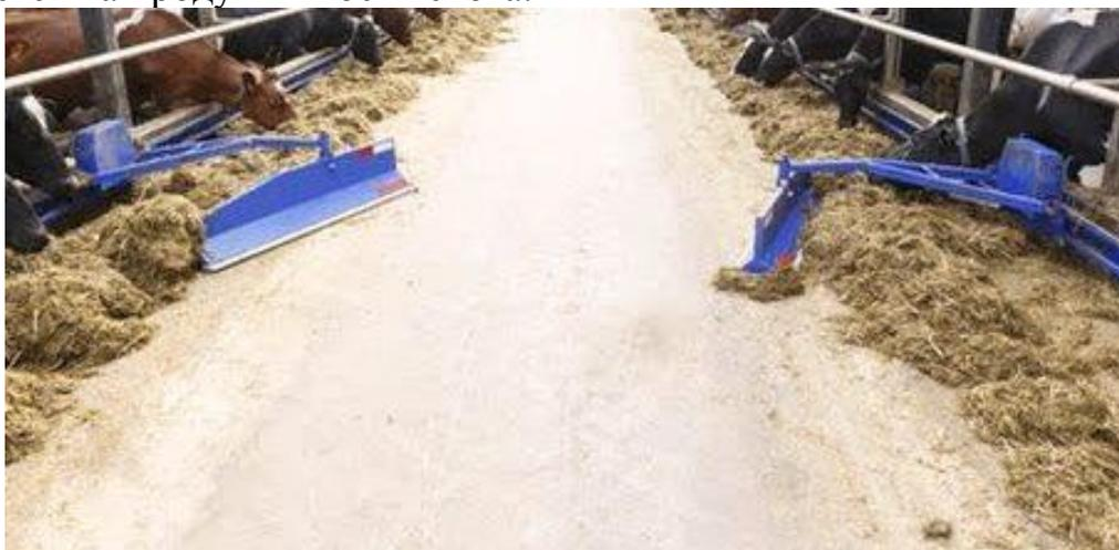
Рисунок 1 – Процесс работы робота-пушера.
