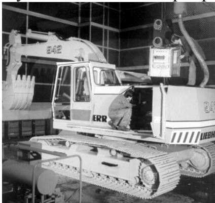
Рис. 4. Стенд для заводських випробувань елементів гідроприводу
