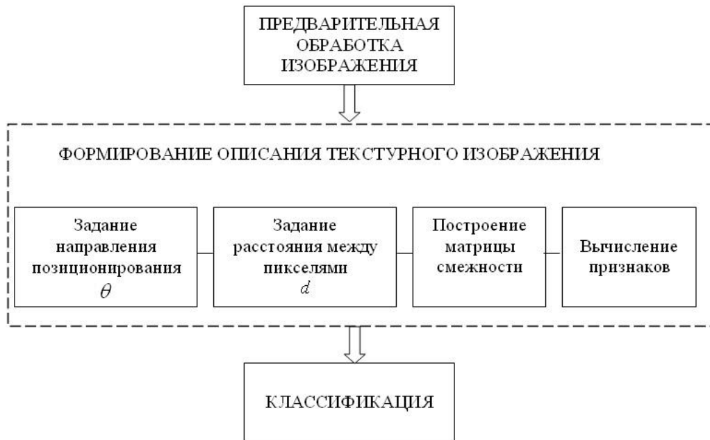
Рис. 2. Структура подсистемы ИС для распознавания текстур зон дефектов цифровых изображений режущей части.
