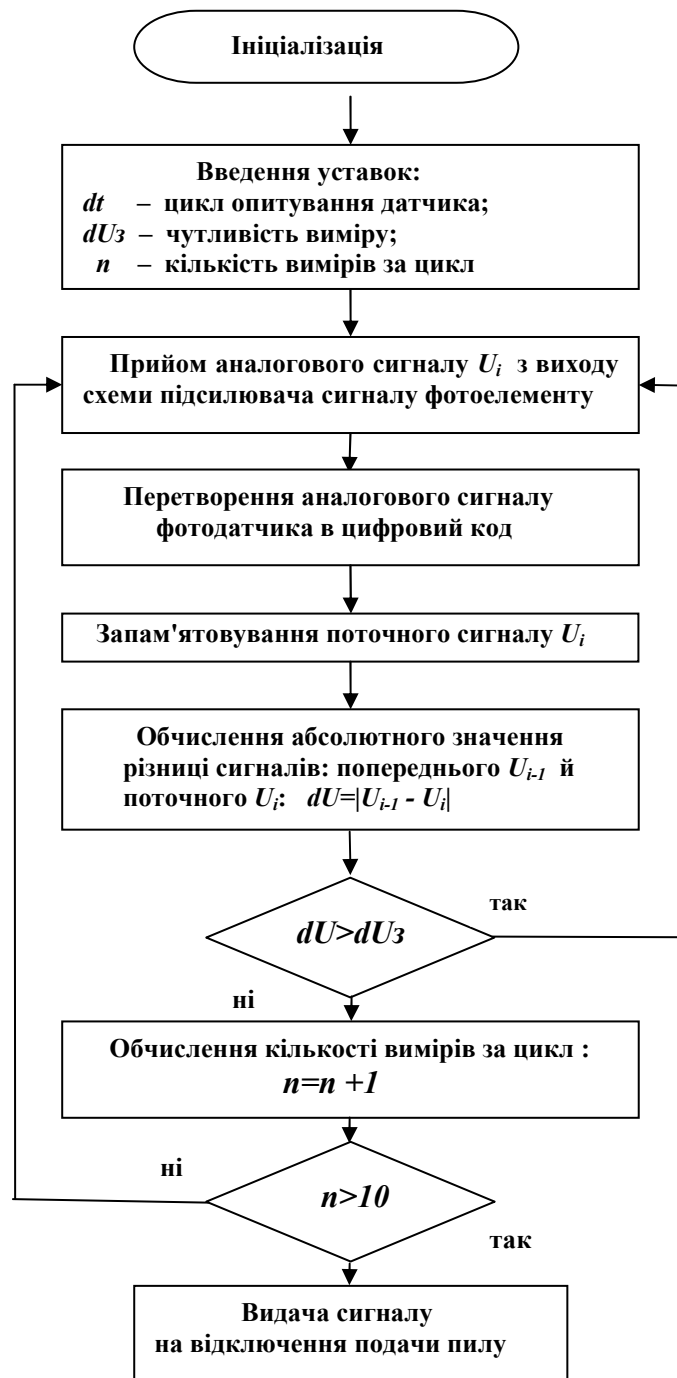
Рис. 5. Блок - схема роботи системи контролю наявності горіння факелу.
