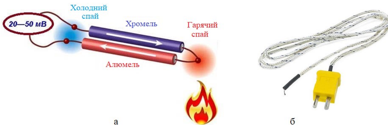
Рис. 9. Принцип роботи хромель-алюмелевої термопары (а) та її загальний вигляд (б)
