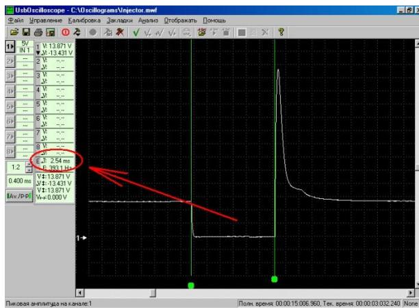
Рис. 8. Осциллограмма сигнала управления форсунками
