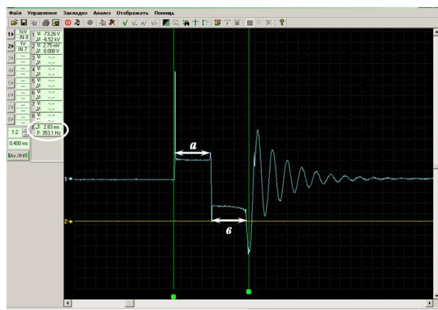
Рис. 4. Фрагмент осцилограммы биполярной системы зажигания
