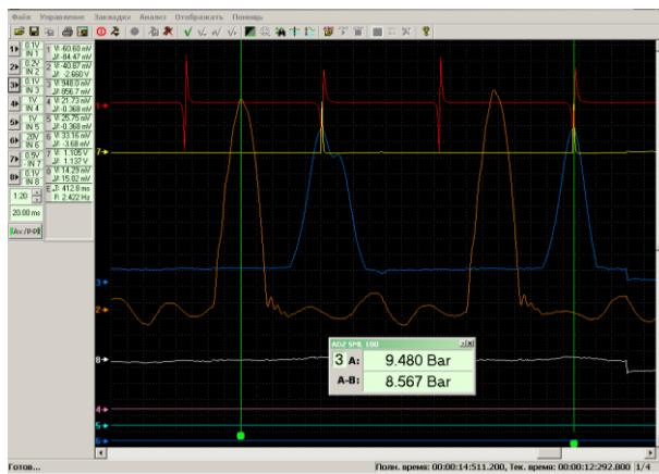
Рис. 3. Пример осцилограмм при исследовании рабочего процесса ДВС
