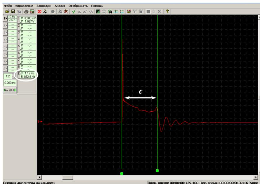
Рис. 5. Фрагмент осциллограммы серийной системы зажигания
