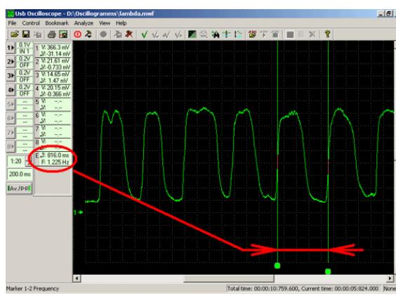
Рис. 9. Осциллограмма выходного напряжения лямбда-зонда BOSCH
