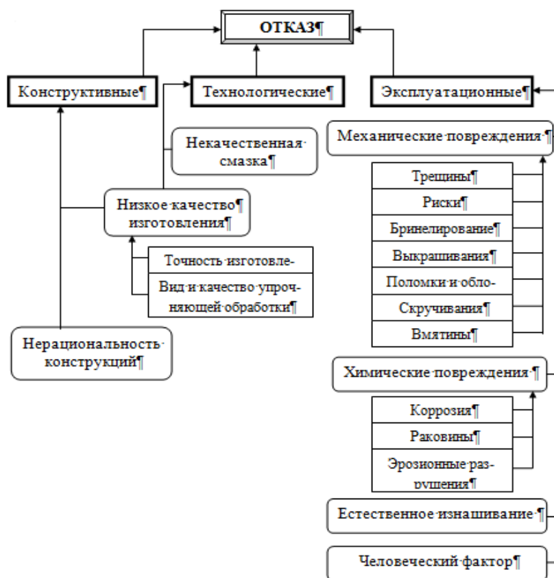
Рис. 1. Схема отказа карданных подшипниковых узлов
