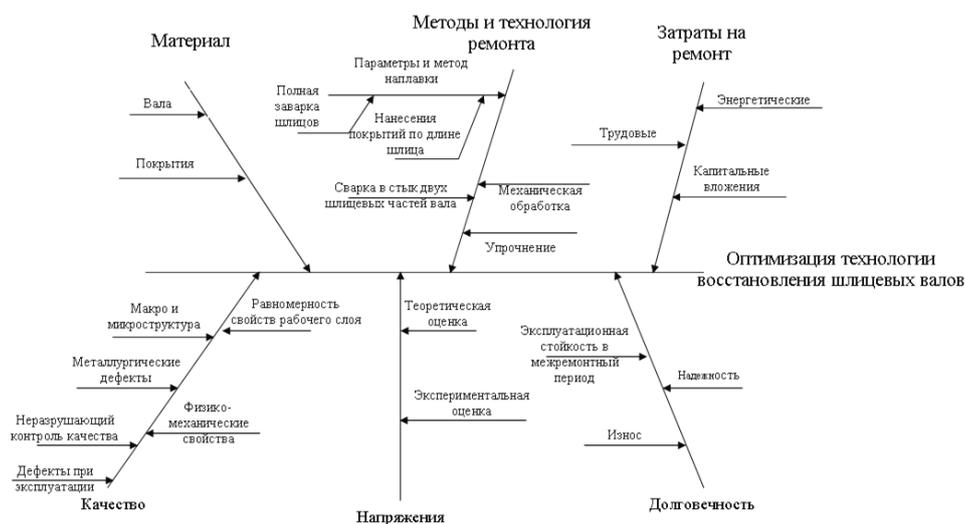
Рис.1 Диаграмма оптимизации технологии восстановления шлицевых валов
