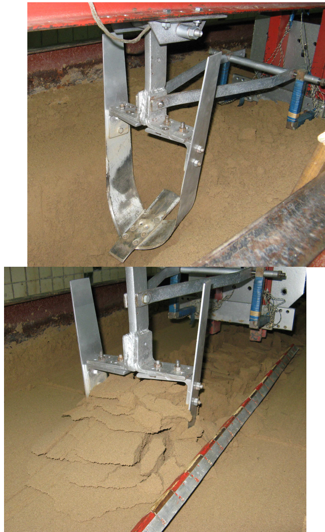
Рисунок 1. Лабораторні дослідження скоби в ґрунтовому каналі: a – модель скоби; б – робочий момент взаємодії моделі з ґрунтом
