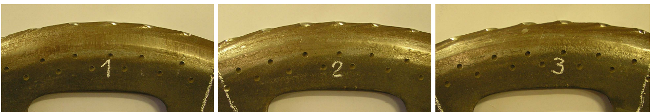
Рис. 3. Загальний вигляд секторів диска після напрацювання 240 га з параметрами: а) – t_3 = 35 мм, h_3 = 2 мм; б) – t_3 = 35 мм, h_3 = 2,5 мм; в) – t_3 = 35 мм, h_3 = 3 мм
