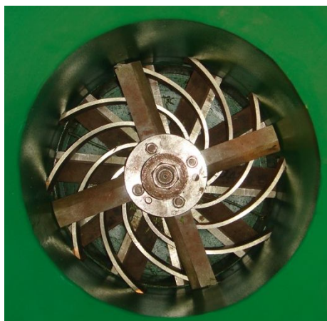
Рисунок 3 – Общий вид камеры измельчения с установленными экспериментальными криволинейными противорезами.
