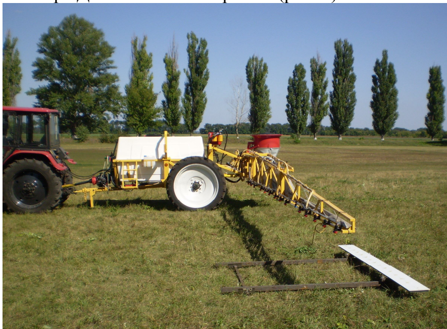
Рис. 1. Лабораторно-польові випробування обприскувача
