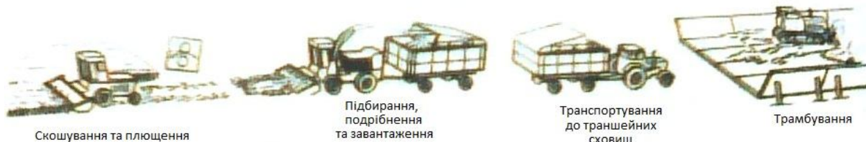
Рис. 4 – Технологія заготівлі сінажу
