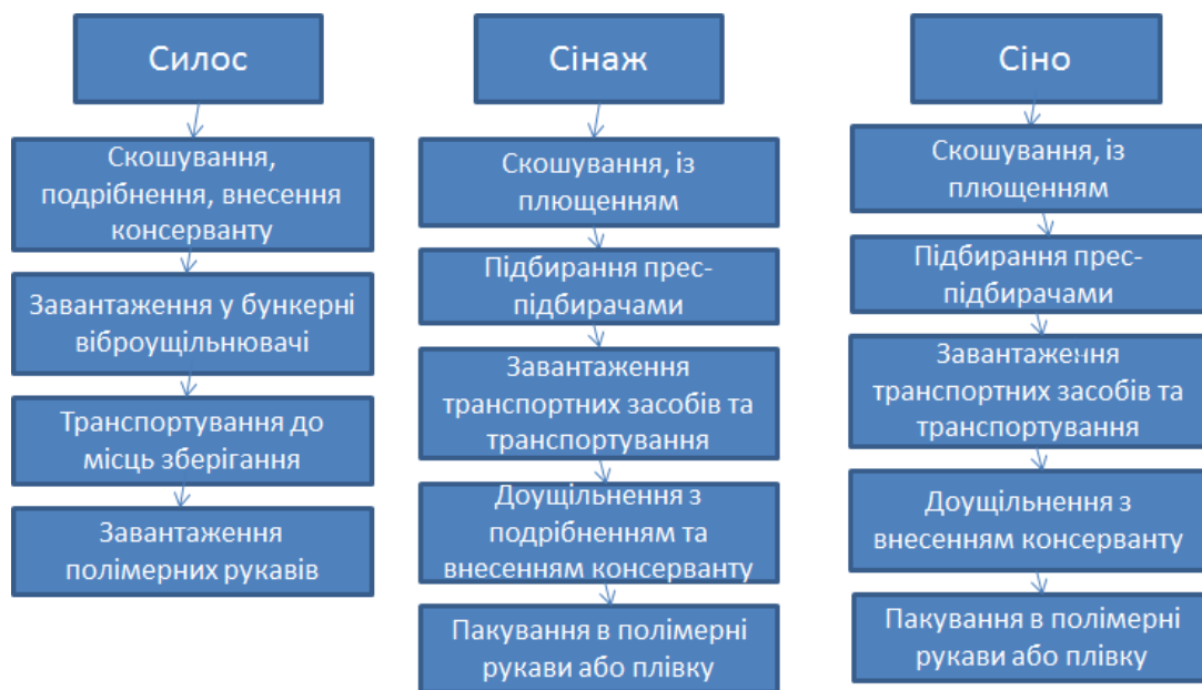
Рис. 7. Технології виробництва силосу, сінажу та сіна
