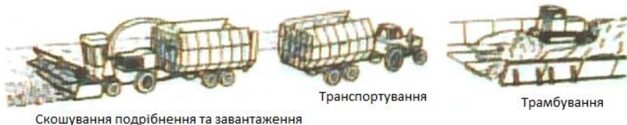
Рис. 5. Технологія заготівлі силосу
