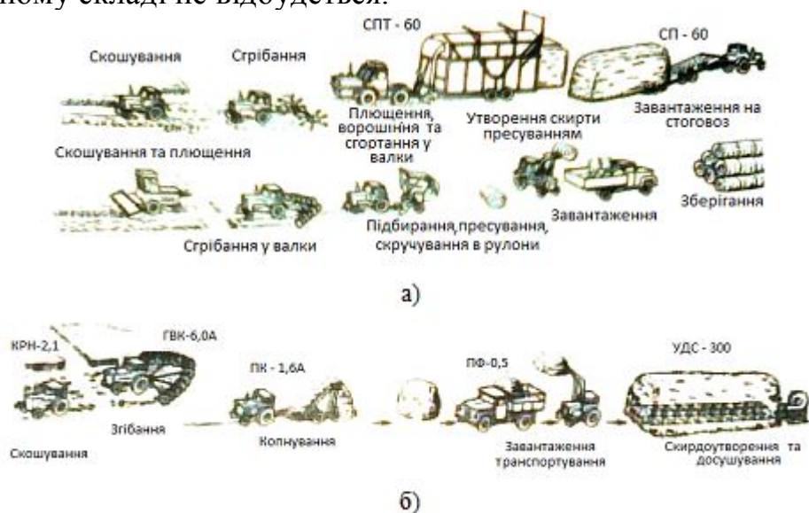
Рис. 3. Технологія заготівлі пресованого (а) та розсипного сіна (б)
