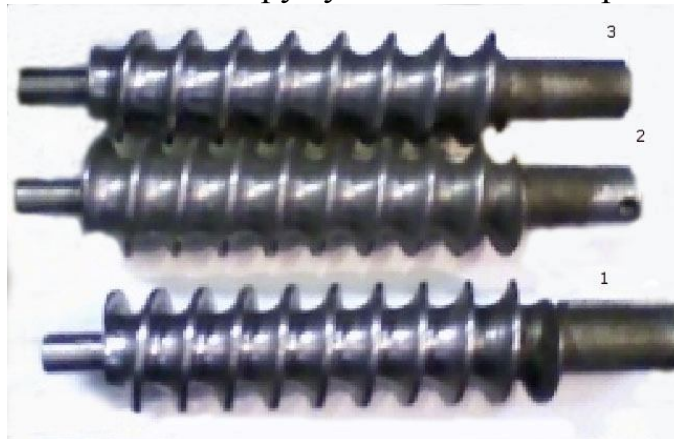
Рис.2. Конструкції однозахідних шнекових валів: 1 – шнековий вал з кроком витків 0,020 м; 2 – шнековий вал з кроком витків 0,022 м; 3 – шнековий вал з кроком витків 0,024 мм.
