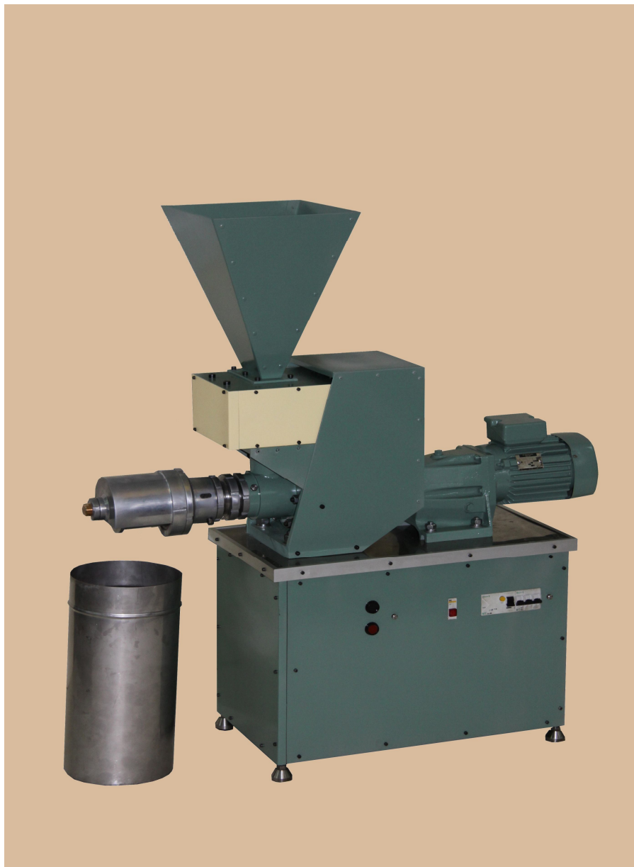
Рис.2. Загальний вигляд конусного злущувача-подрібнювача насіння розторопші плямистої КЗПН – 50.
