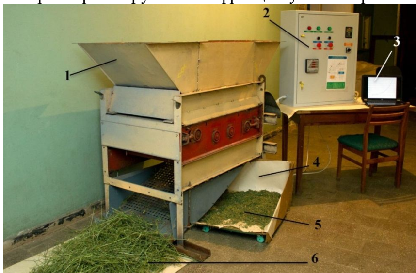
Рис. 1. Стенд для експериментальних досліджень: 1 – установка для фракціонування сухої листостеблової маси; 2 – частотний регулятор Danfoss; 3 – персональний комп'ютер із програмним забезпеченням; 4 – приймальний лоток; 5 – листова фракція; 6 – стеблова фракція.
