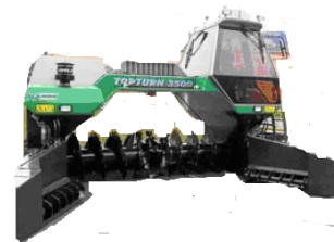
з - Topturn, 3500 G (Австрія) самохідний, гусеничний, фронтальний, з активними дільниками, шнеково-роторний з трикутною рамкою, потужність д.в.з. 112 кВт
