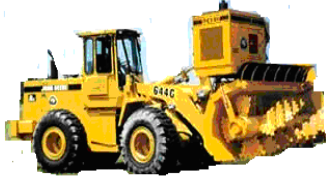
в - SC3110 Brown Bear (Австралія) навісний, фрезерні робочі органи, зрушення матеріалу вправо, встановлений бак з рідиною, арочна форма рамки
