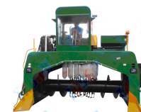
к - TAGR M3600 (Китай) самохідний, колісний, фронтальний, шнеко-пальцевий ротор з трапецієвидною рамкою, пасивні дільники, ширина захоплення 3,6 м, висота бурту до 1,8 м, потужність д.в.з. 180 кВт
