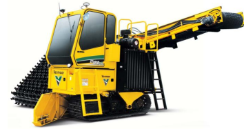
б - Vermeer CT 1010 TX (США) самохідний, елеваторно-конверсний з боковим вивантаженням, гусеничний з пасивним дільником, потужність д.в.з. 160 кВт
