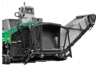
ж - Topturn X53, X60, X67, КОМПТЕСН (Австрія) самохідний, гусеничний, фронтальний з бічним вивантаженням, - висота бурту 2,38-3,1 м, ширина захоплення 5-6,4 м, потужність д.в.з. 242-328 кВт
