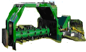
а - Aeromaster PT-120 (США) причіпний, роторний робочий орган – трапецієвидна рамка, потужність трактора 60 кВт
