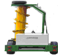
г - PRT 2500, PEZZOLATO (Італія) причіпний, шнековий робочий орган, трапецієвидна рамка, бак з рідиною, вертикальне транспортування робочого органу, потужність д.в.з. до 50 кВт.
