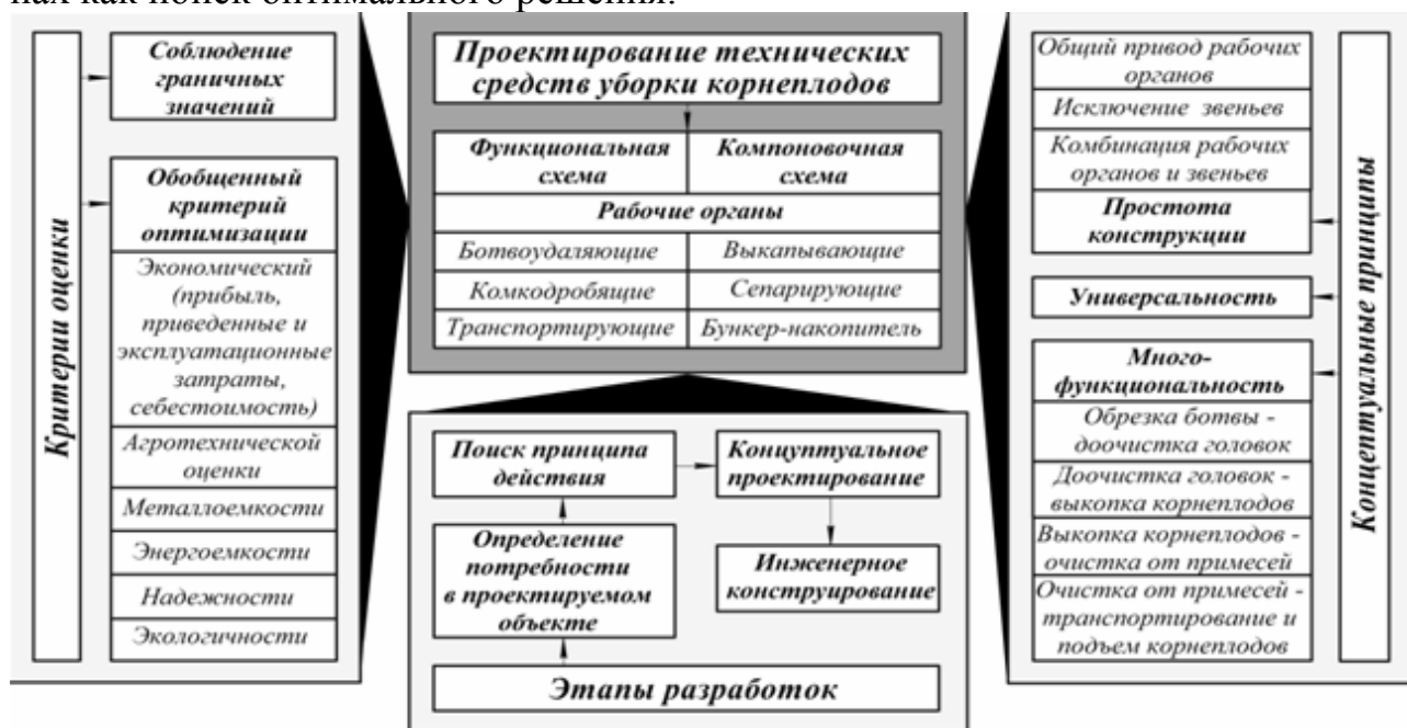
Рисунок 3 – Структурная схема разработки технических средств уборки корнеплодов
