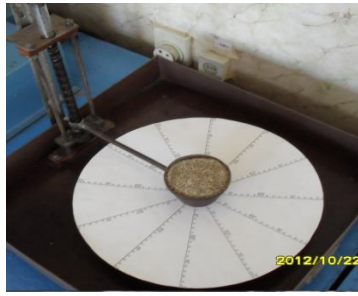
Рис. 1. Визначення кута внутрішнього тертя преміксу за допомогою установки «конічна ємність»
