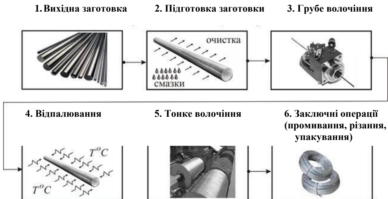
Рисунок 24.8 – Технологічний процес отримання дроту методом волочіння
