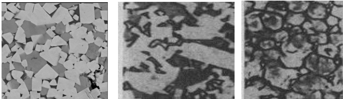
Рисунок 13.2 – Мікроструктура твердих сплавів, \times 100 : а – Т15К6; б – Т15К6; в – Т30К4
