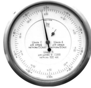
Рисунок 5.2 – Твердомір ТК-2 а – схема твердоміра; 6 – шкали індикатора; 1 – зразок; 2 – наконечник; 3 – гвинт кріплення наконечника; 4 – обмежувач; 5 – пружина; 6 – шпindel; 7 – індикатор; 8 – трос; 9 – вантажний важіль; 10 – опора; 11, 12 – змінні важки; 13 – постійний важок; 14 – шток; 15 – кулачковий блок; 16 – ручка; 17 – редуктор; 18 – електродвигун; 19 – гвинт; 20 – клавіша; 21 – барабан; 22 – маховик; 23 – столик
