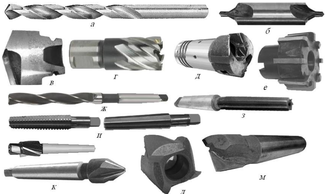
Рисунок 23.2 – Інструменти свердильних станків: а – свердло спіральне; б – свердло центрувальне; в – свердло перове; г - свердло кільцеве; д – свердло інжекторне; е – зенкер насадний; ж – зенкер кінцевий; з – розвертка машинна; и – комплект конічних розверток; к – зенківки циліндрична та конічна; л – цековка насадна; м – цеківка кінцева
