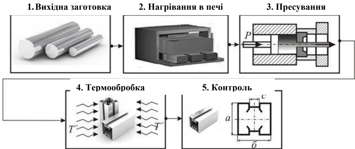
Рисунок 24.6 – Технологічний процес отримання алюмінієвого профілю методом пресування
