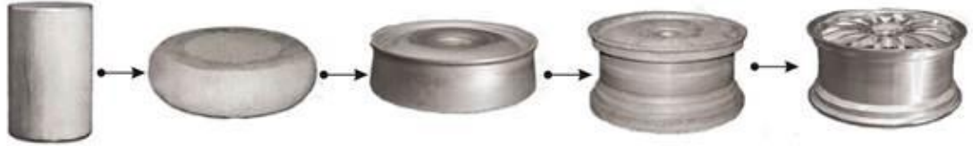
Рисунок 24.14 – Технологічний процес отримання колесного диску із алюмінієвого сплаву куванням під пресом
