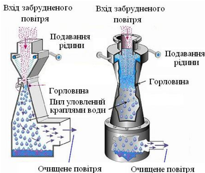
Рисунок 7.4 – Скрубер Вентурі
