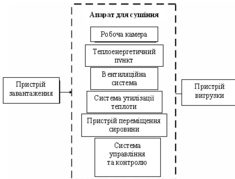
Рисунок 4.1 – Універсальна функціональна схема сушильних апаратів
