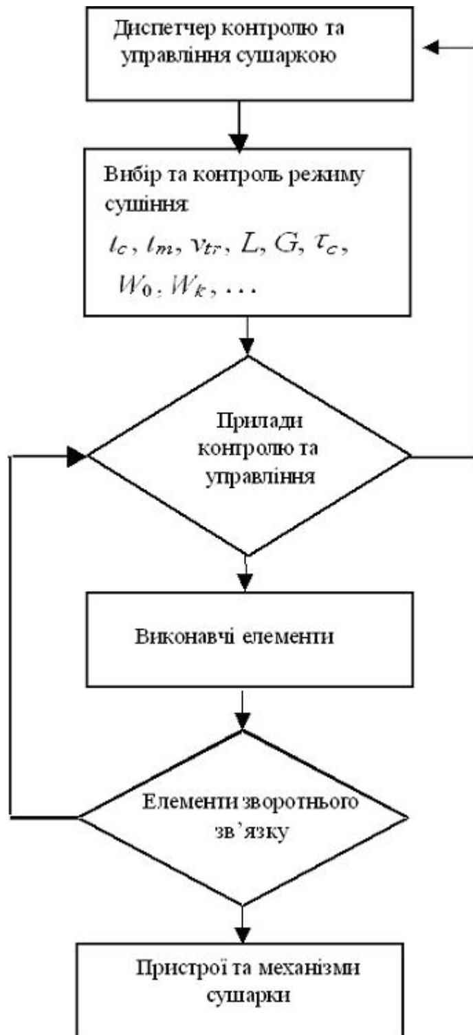
Рисунок 5.1 – Функціональна блок-схема системи контролю та управління сушарки
