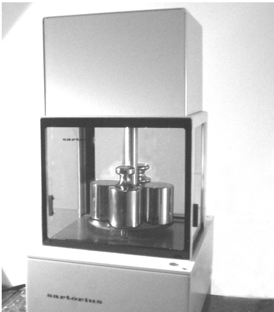
Рисунок 5.2 – Вторинні еталони та компаратор маси СС50 фірми Sartorius. Фотографія надана ННЦ «Інститут метрології» (м. Харків)
