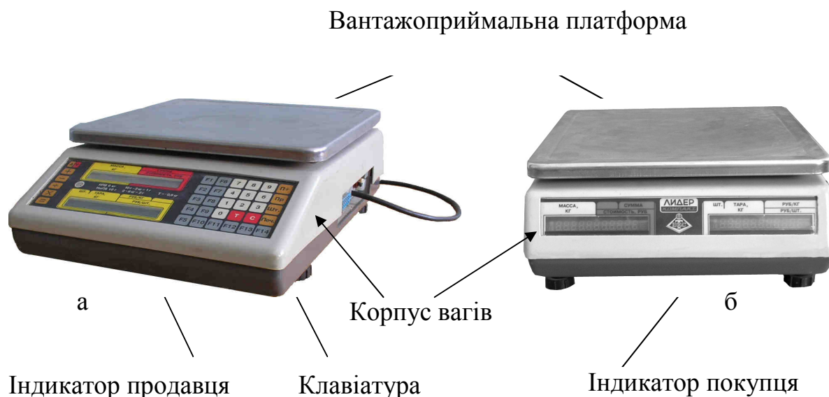
Рисунок 3.6 – Ваги електронні торгові ВР4149 «Лідер»: а – вигляд з боку продавця; б – вигляд з боку покупця
