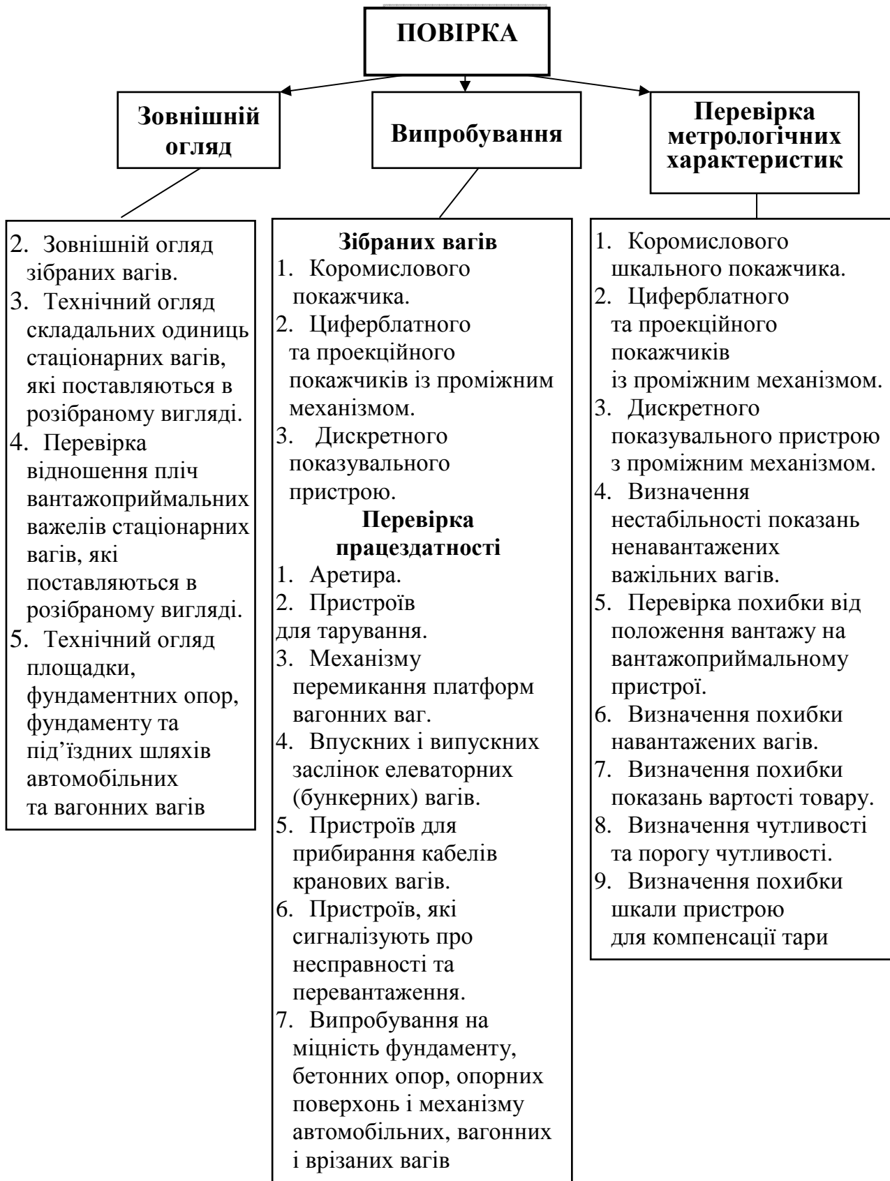
Рисунок 5.4 – Схема операцій повірки вагів для статичного зважування
