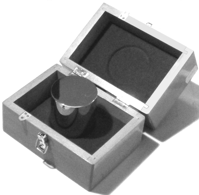
Рисунок 5.1 – Державний первинний еталон одиниці маси України – 1 кг. Фотографія надана ННЦ «Інститут метрології» (м. Харків)
