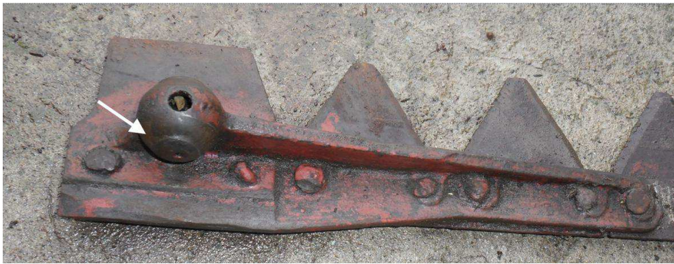
Рисунок 4 – Елемент з'єднувального шарніра косарки
