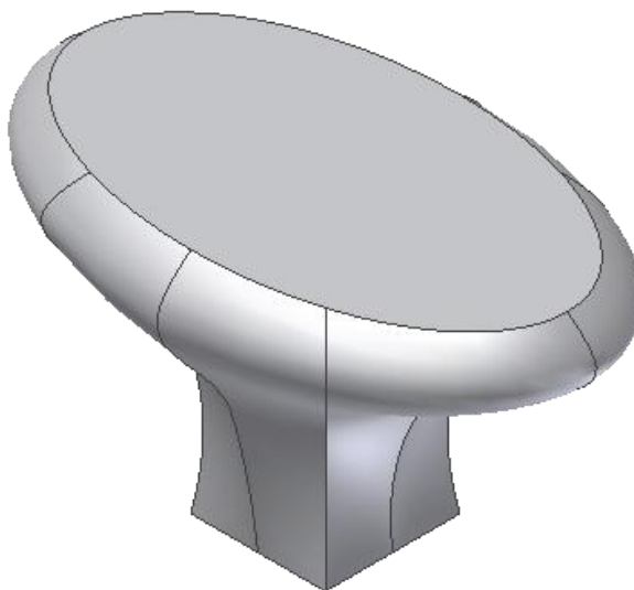
Рис. 2.37 – Ручка, деталь змінного перерізу
