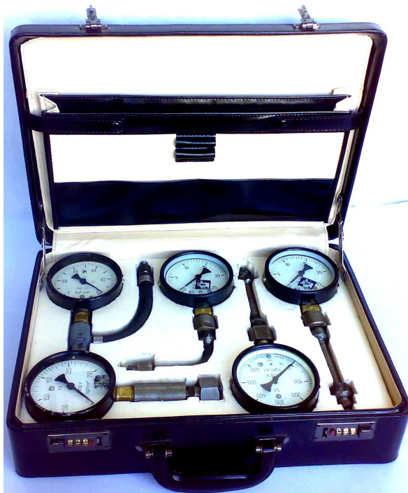
Рис. 1. Переносний комплект засобів для діагностування ГСТ-90, основної гідросистеми та гідросистеми рульового керування
