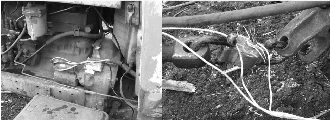
Рис. 2 – Приклади розташування датчиків на мобільних енергетичних засобах
