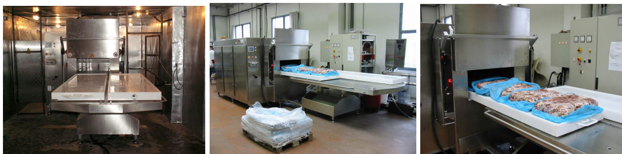
Рисунок 11.24 – Мікрохвильовий дефростер AMW 600 в роботі: 1 – апарат перед початком роботи; 2 – продукт перед завантаженням на розморожування; 3 – продукт після розморожування
