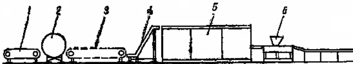
Рисунок 9.76 – Поточна лінія для виробництва морожених ягід у дрібному упакованні: 1 – стрічковий транспортер (інспекційний); 2 – мийна машина; 3 – сітчастий транспортер; 4 – елеватор; 5 – флюїдизаційний морозильний апарат; 6 – фасувальний автомат
