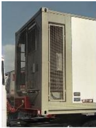
Рисунок 5.15 – Торцевий відсік і двері великотоннажного рефрижераторного контейнера: а – вбудований холодительно-опалювальний агрегат; б – двері та внутрішнє обладнання контейнера
