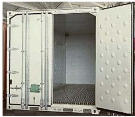
Рисунок 5.15 – Торцевий відсік і двері великотоннажного рефрижераторного контейнера: а – вбудований холодительно-опалювальний агрегат; б – двері та внутрішнє обладнання контейнера
