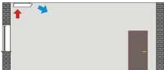
Рисунок 6.16 – Схема руху повітря при установці підстельового внутрішнього блока
