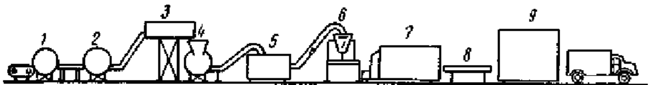
Рисунок 9.72 – Поточна лінія для виробництва мороженого овочевого пюре: 1 – мийна машина; 2 – машина для очищення та розділення; 3 – бланшувачі; 4 – протиральна машина; 5 – дозуючий та перемішуючий пристрій; 6 – наповнювач; 7 – морозильний апарат із непрямим контактом; 8 – пакувальний апарат; 9 – камера зберігання
