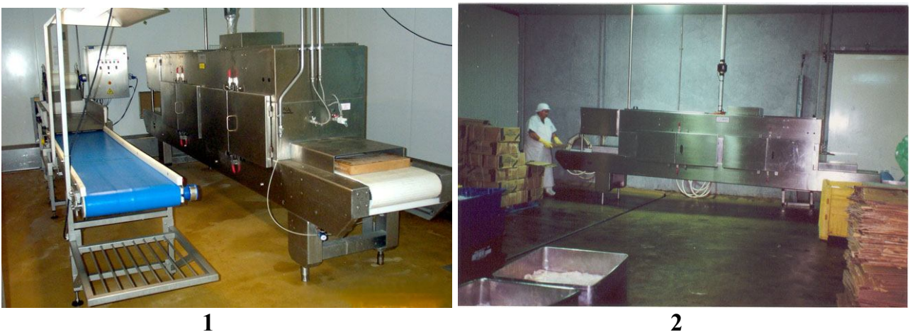
Рисунок 11.21 – Процес роботи дефростера TRF 50: 1 – продукт завантажений для розморожування; 2 – вивантаження продукту після розморожування
