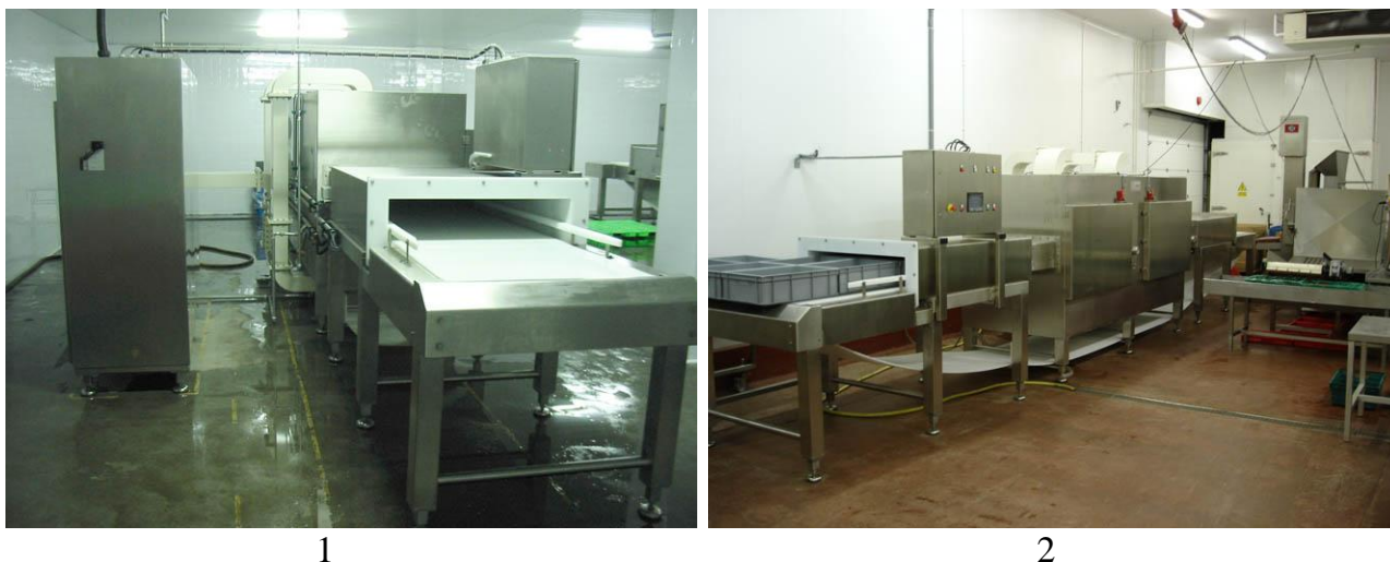
Рисунок 5.25 – Мікрохвильові дефростери тунельного типу: 1 – TMW 75; 2 – TMW 150
