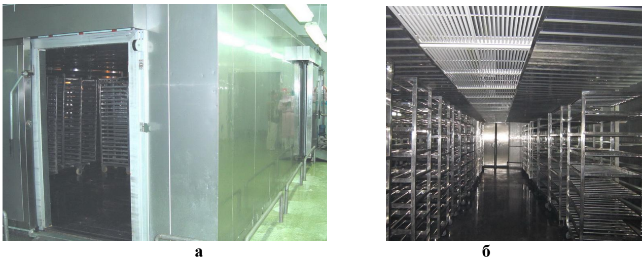
Рисунок 5.5 – Камера дефростації серії VGKL: а – зовнішній вигляд; б – вигляд візків всередині камери
