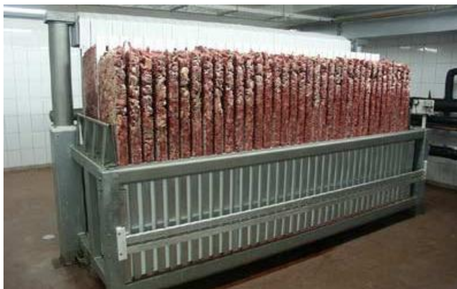
Рисунок 3.41 – Вертикально-плитковий апарат у положенні для вивантаження
