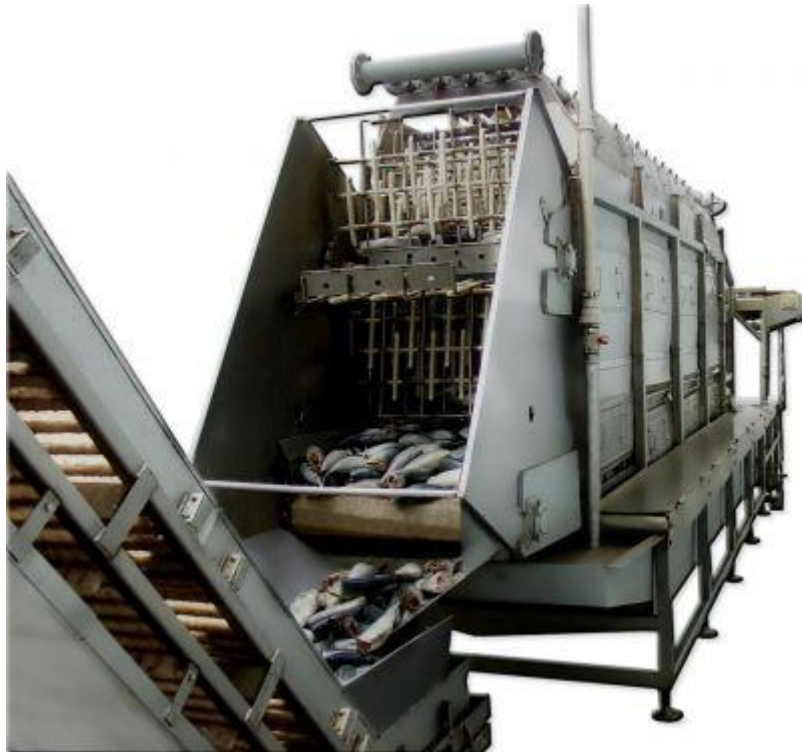
Рисунок 11.14 – Дефростер універсальний Н2-ИТА112
