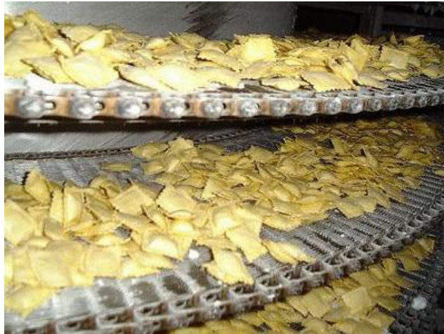
Рисунок 3.18 – Заморожування продукту в спіральному морозильному апараті
