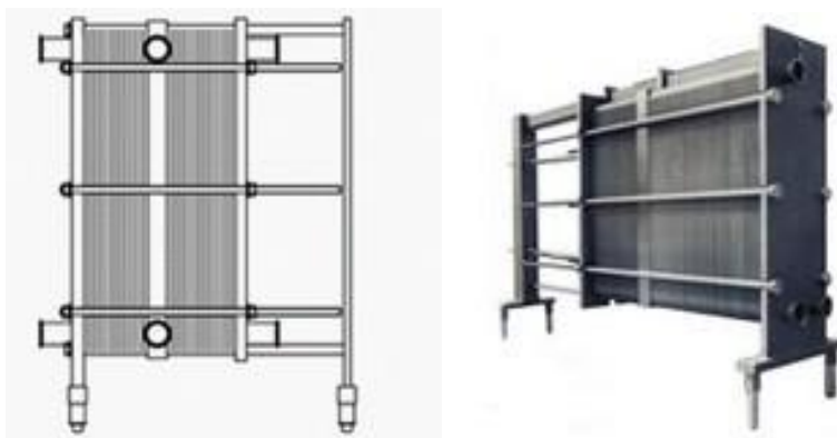
Рисунок 2.36 – Загальний вигляд пластинчастого охолоджувача молока 001-В10 (ООЛ-10)
