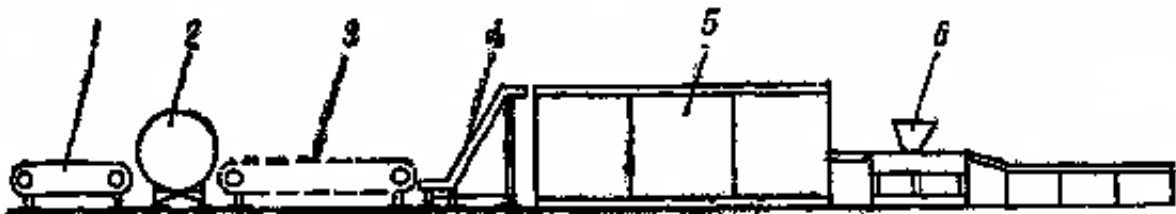
Рисунок 3.76 – Поточна лінія для виробництва морожених ягід у дрібному упакованні: 1 – стрічковий транспортер (інспекційний); 2 – мийна машина; 3 – сітчастий транспортер; 4 – елеватор; 5 – флюїдизаційний морозильний апарат; 6 – фасувальний автомат
