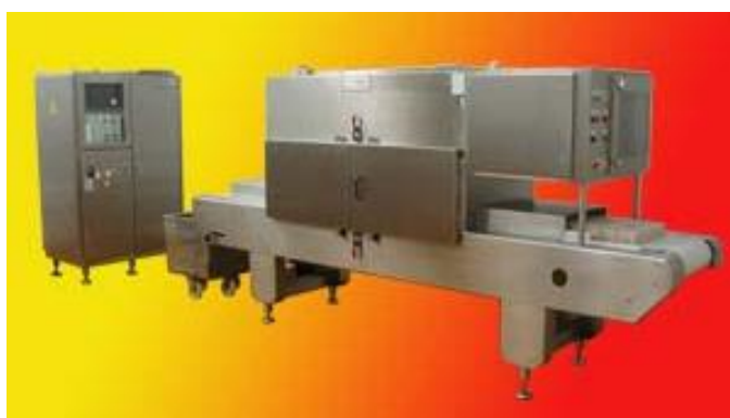
Рисунок 5.19 – Дефростери високочастотні, тунельні: 1 – TRF 20; 2 – TRF 50
