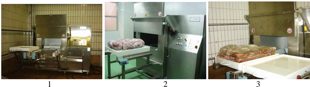
Рисунок 5.23 – Мікрохвильовий дефростер AMW 200 в роботі: 1 – апарат перед початком роботи; 2 – продукт перед завантаженням на розморожування; 3 – продукт після розморожування
