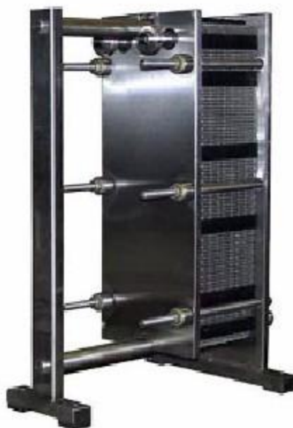
Рисунок 2.37– Загальний вигляд пластинчастого охолоджувача молока ООЛ-25
