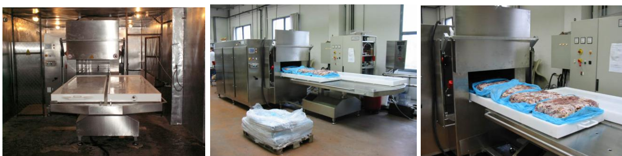
Рисунок 5.24 – Мікрохвильовий дефростер AMW 600 в роботі: 1 – апарат перед початком роботи; 2 – продукт перед завантаженням на розморожування; 3 – продукт після розморожування
