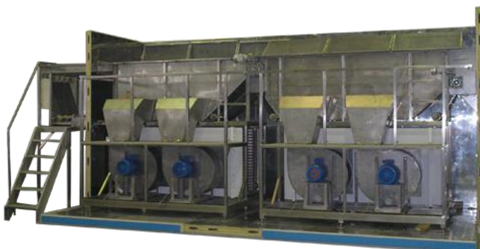
Рисунок 3.26 – Флюїдизаційний морозильний апарат (розріз)
