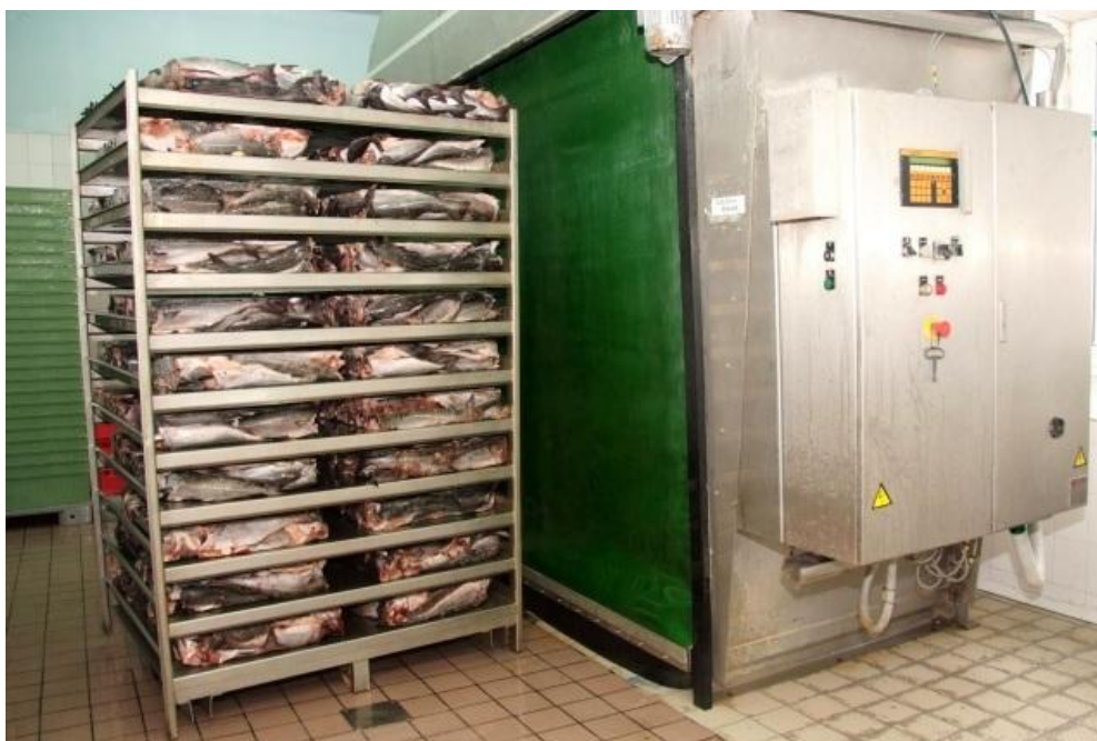
Рисунок 5.4 – Дефростер Cabinplant TC- 2
