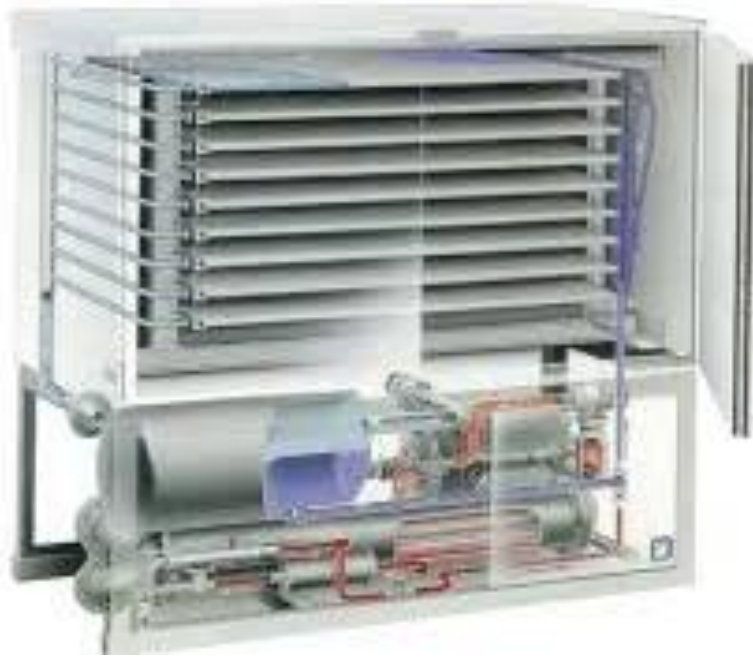
Рисунок 3.33 – Загальний вигляд плиткового морозильного апарата
