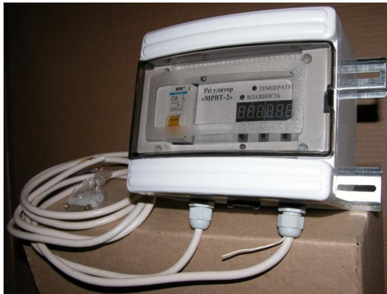
Рисунок 4.34 – Мікропроцесорний регулятор вологості й температури «MRBT»
