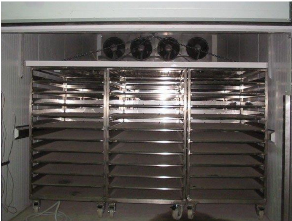
Рисунок 5.2 – Розташування візків в камері дефростації
